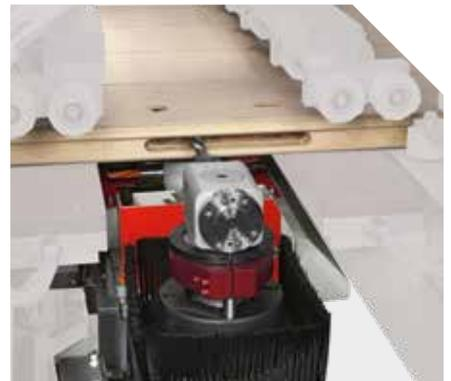
Possibilité d'utilisation d'agrégats pour l'usinage des portes et pour l'application du Clamex "lamello". (opt.)
