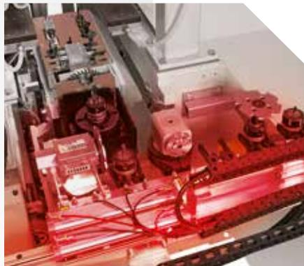
Configuration des groupes opérateurs: tête de perçage, rainurage, groupe de fraisage (4,5 kW) avec changeur d'outils à 6 positions.
